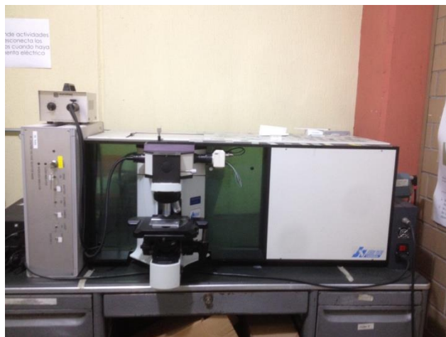
Figura 5. Espectrómetro Raman utilizado para la caracterización de las muestras, ubicado en el campus Rosedal de la Facultad de química de la UAEM.
